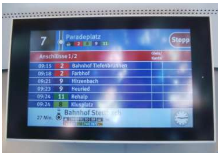
Fot. 14.2.2. Tablica LCD wewnątrz pojazdu, prezentująca szczegółowe możliwości przesiadki na najbliższym przystanku według schematu: godzina odjazdu – linia – kierunek (Zurych).
