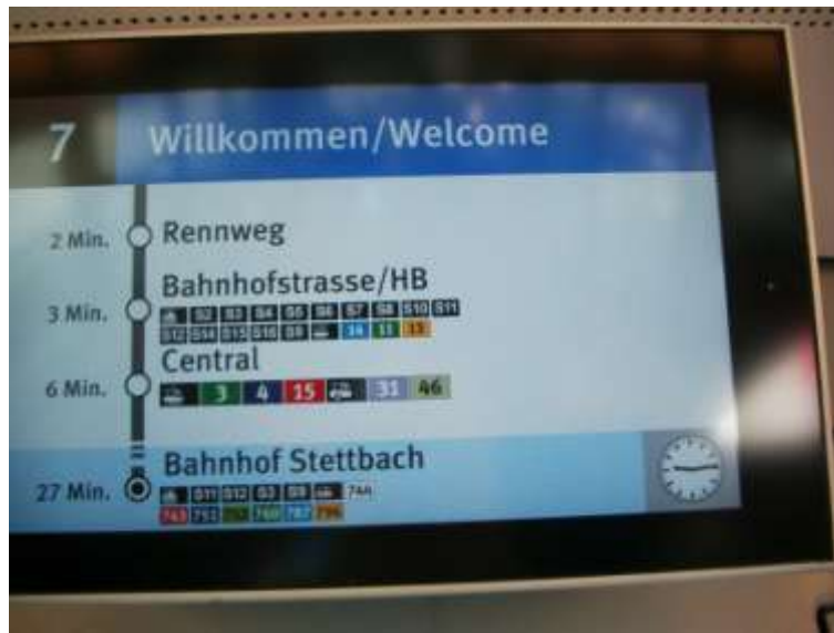
Fot. 14.2.1. Tablica LCD wewnątrz pojazdu, prezentująca kolejne przystanki wraz z możliwościami przesiadki na poszczególne linie (Zurych).
